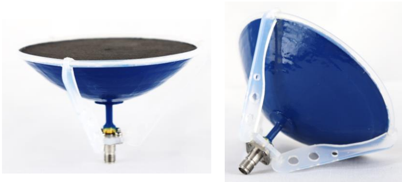
2450MHz 小型凹面鏡アンテナ ビームパターン 利得: 7.6dBi (右旋円偏波アンテナ対向)
